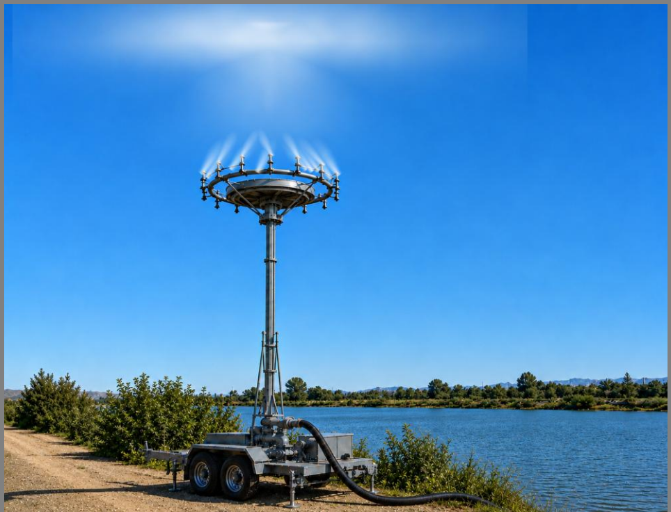
Abbildung zeigt eine mobile Ringdüsen-Sprüheinheit, direkt an einem Gewässer
