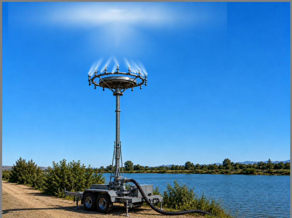
Abbildung zeigt eine mobile Ringdüsen-Sprüheinheit, direkt an einem Gewässer
